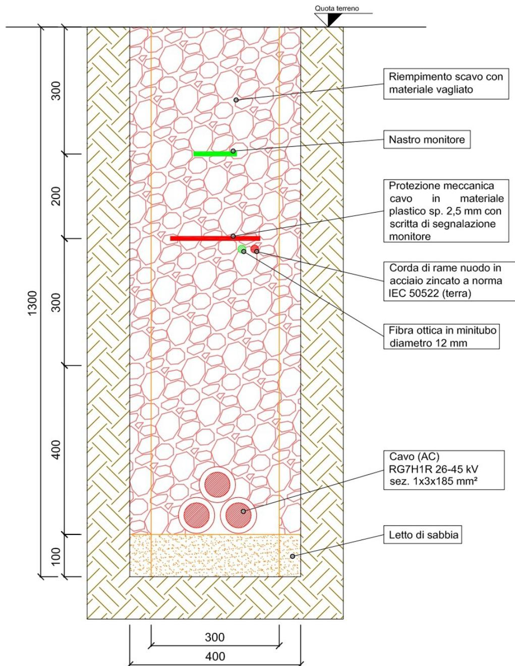
Fig. 6.5.6-5 Tipico sezione di posa con un cavidotto da 3x185mm<sup>2</sup>
