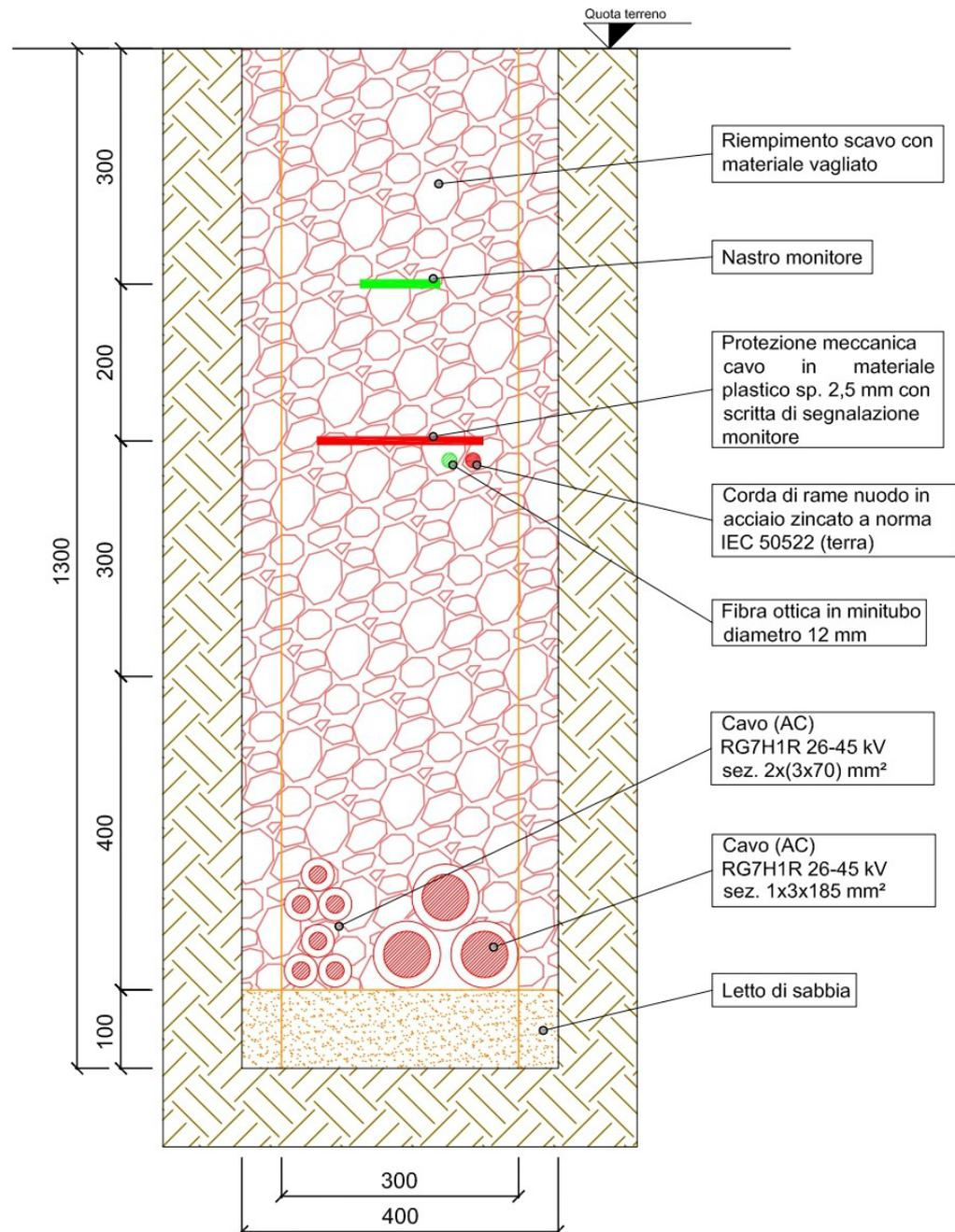
Fig. 6.5.6-6 Tipico sezione di posa con un cavidotto da 3x185mm<sup>2</sup> e due da 3x70mm<sup>2</sup>
