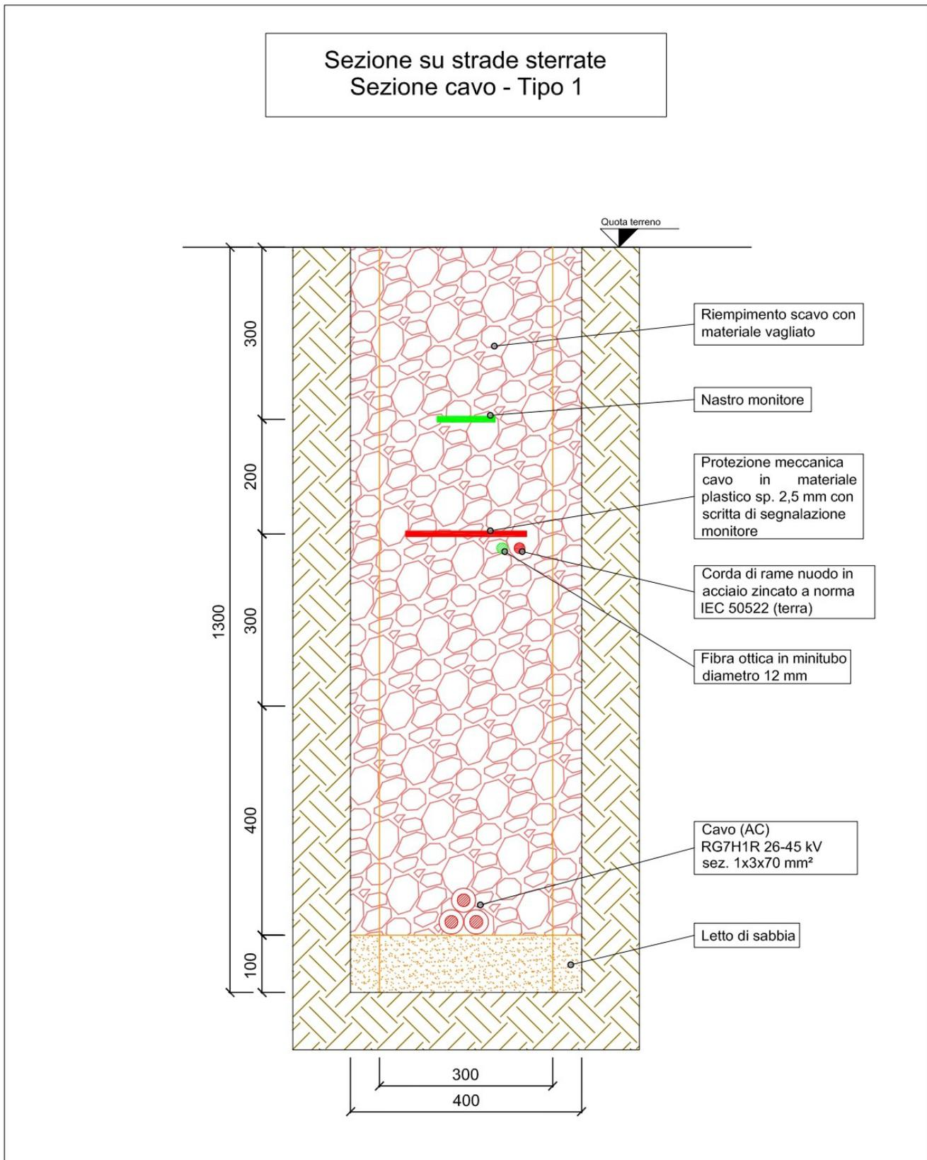
*Fig. 6.5.6-1 Tipico sezione di posa con un cavidotto interno da 3x70 mm<sup>2</sup>*
