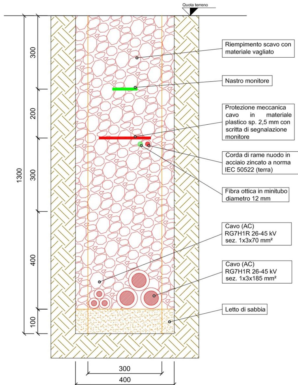
Fig. 6.5.6-6 Tipico sezione di posa con un cavidotto da 3x185mm<sup>2</sup> e uno da 3x70mm<sup>2</sup>
