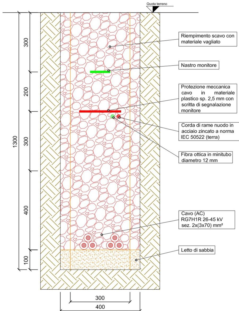
Fig. 6.5.6-2 Tipico sezione di posa con due circuiti interni da 3x70 mm<sup>2</sup>
