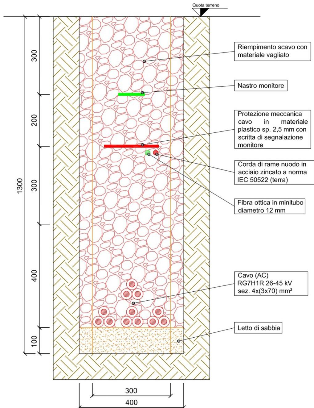
Fig. 6.5.6-4 Tipico sezione di posa con quattro cavidotti da 3x70 mm<sup>2</sup>
