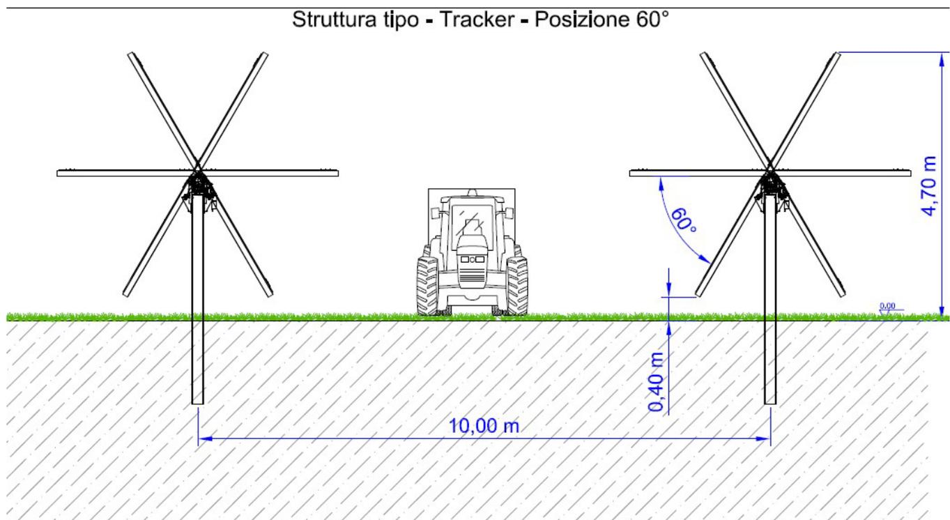
*Fig. 5.4-1 Tipico struttura di supporto – Vista posizione 60°*
