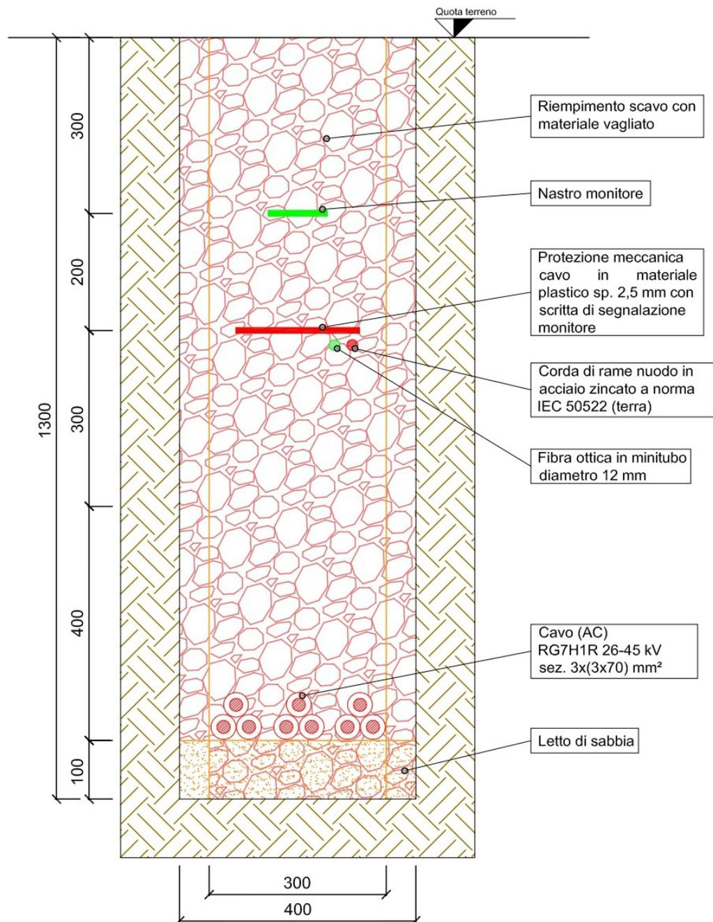
Fig. 6.5.6-3 Tipico sezione di posa con tre cavidotti da 3x70 mm<sup>2</sup>
