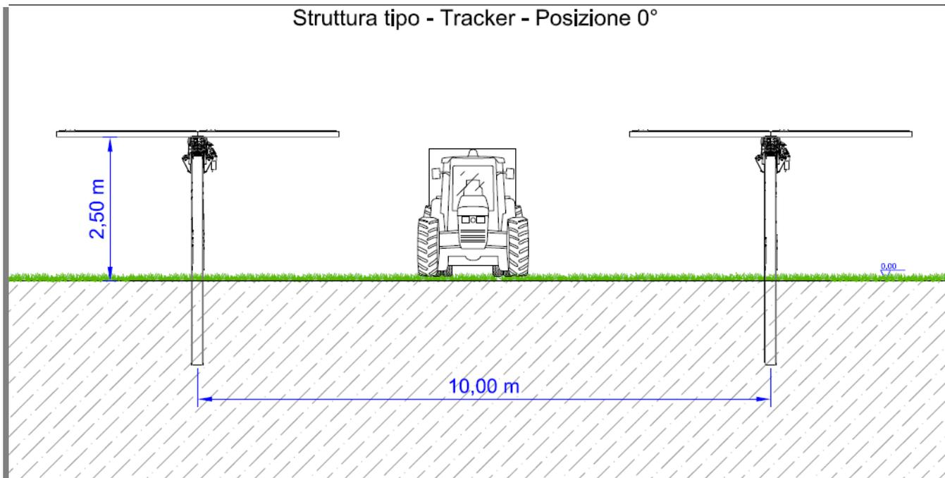
*Fig. 5.4-1 Tipico struttura di supporto – Vista posizione 0°*
