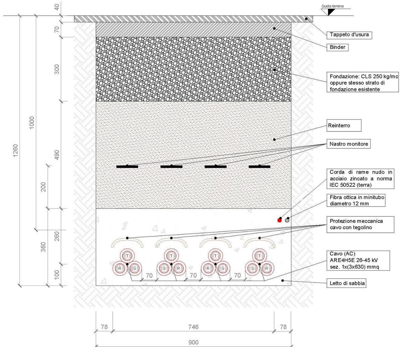
*Fig. 3.3.2-1- Quadrupla Terna di cavi unipolari posati a trifoglio*
