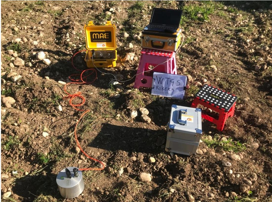
Misura di sismica passiva HVSR
