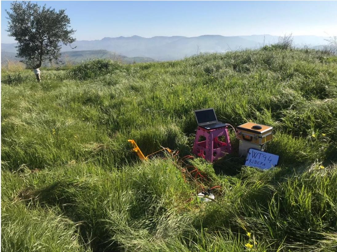
Misura di sismica passiva HVSR
