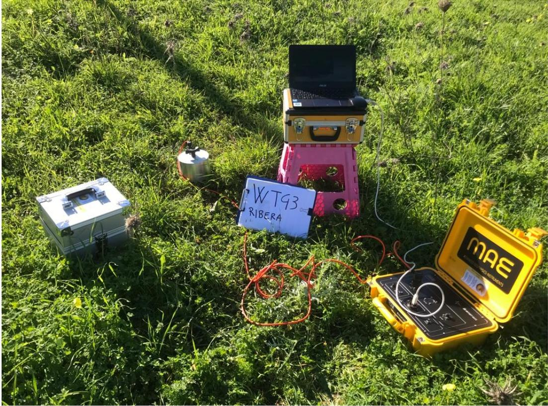
Misura di sismica passiva HVSR
