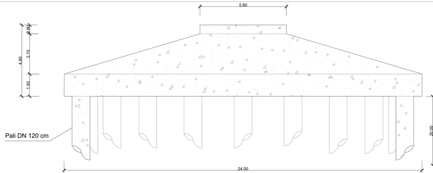
SEZIONE - Fondazione di progetto tipo
