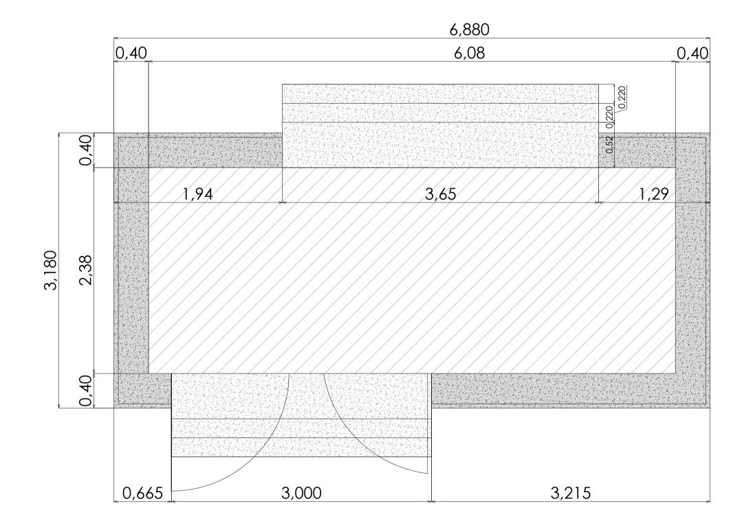
La struttura dei box è realizzata utilizzando un calcestruzzo RcK 400 Kg/cm2 - C 32/40 additivato con idonei fluidificanti e impermealizzanti per fornire protezione contro le infiltrazioni d'acqua dall'esterno. L'armatura è ralizzata con rete elettrosaldata a doppia maglia, irrigidita agli angoli con barre a doppio T.
