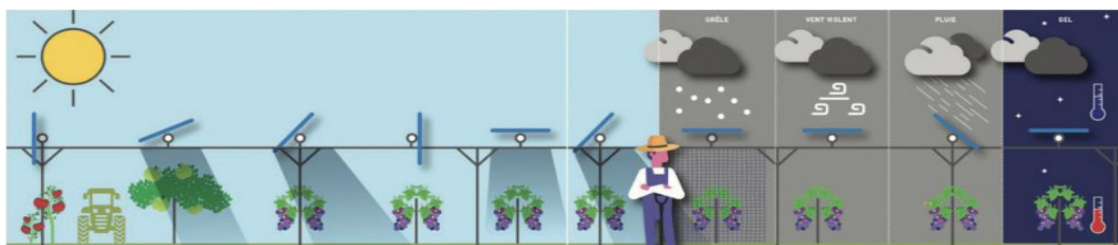
Figura 40. Illustrazione tipologica del funzionamento di un sistema Agrivoltaico (Fraunhofer, 2020).
