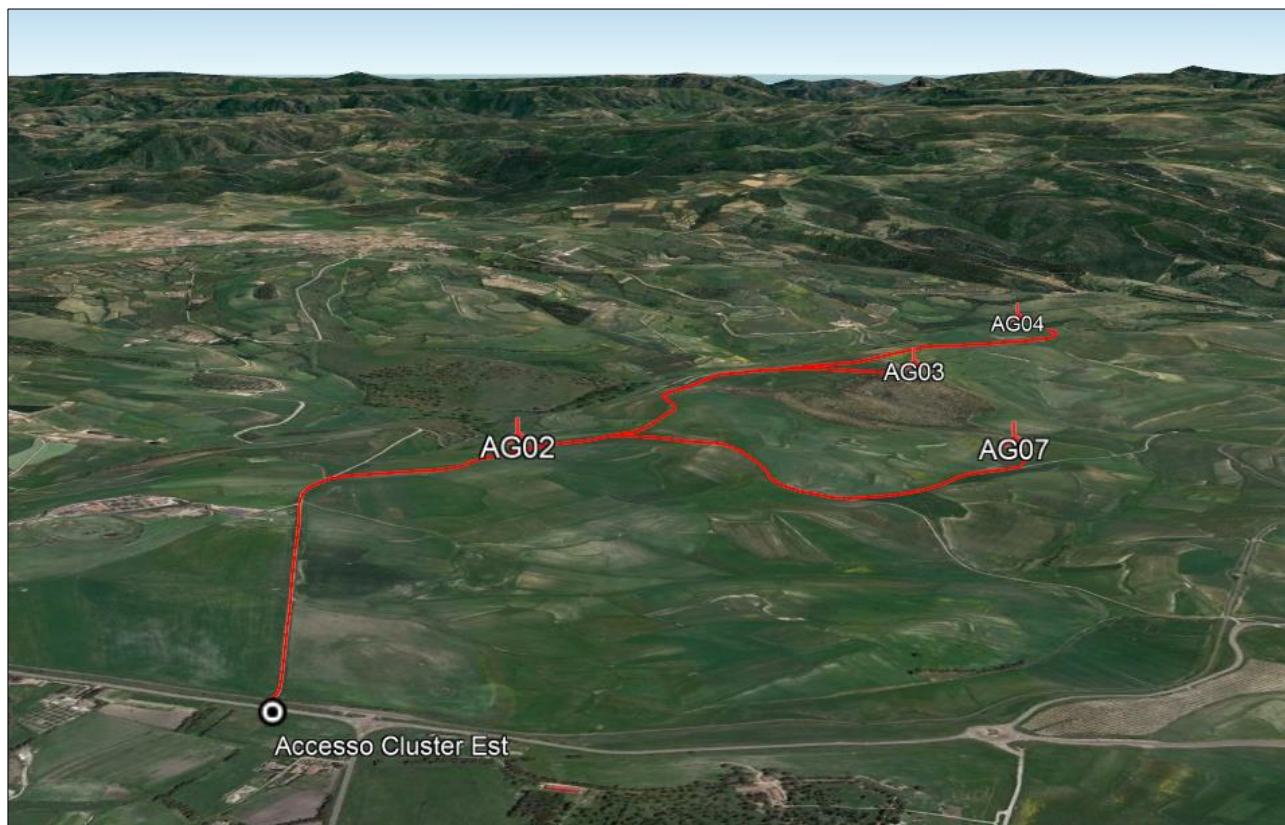
Figura 5.5 – Viabilità di accesso alle postazioni eoliche AG02, AG07, AG03 e AG04 nel territorio collinare di Suelli (prospettiva da ovest)
