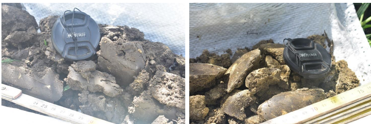
Figura 3.6 – Aggregati dell'orizzonte A campionati nella trivellata. A destra si osservano alcune porzioni di suolo ricoperte di sabbia di colore giallastro provenienti dell'orizzonte R parzialmente alterato.
