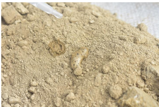
Figura 3.27 – Reazione all'acido indica la presenza di contenuti importanti di carbonati
