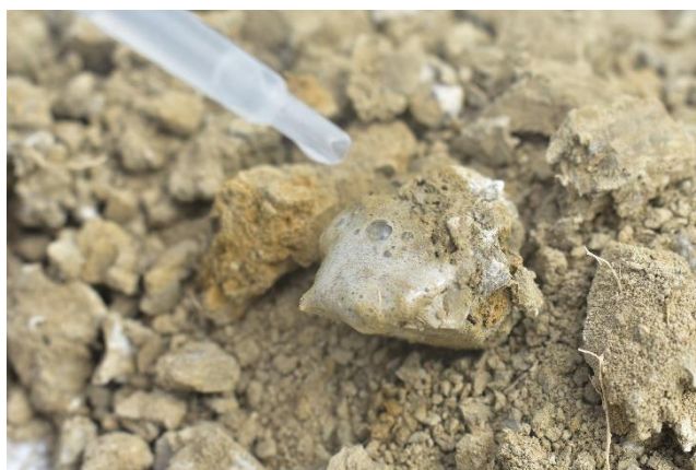
Figura 3.27 – Reazione all'acido indica la presenza di contenuti importanti di carbonati
