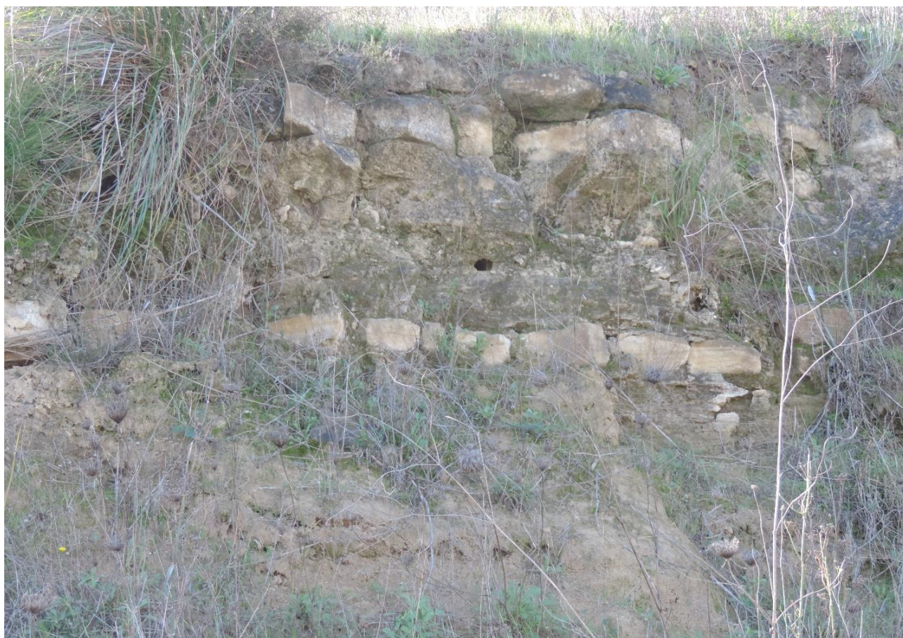
FIGURA 2.6 – Marne della Formazione della Marmilla in giacitura orizzontale nel settore orientale del parco eolico.
