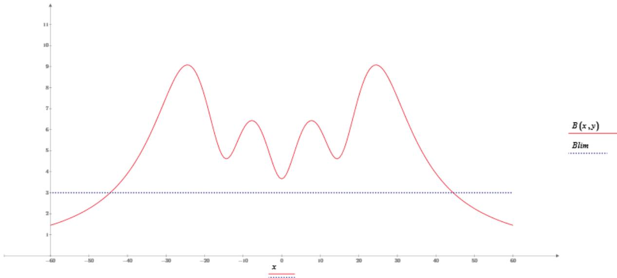
**Figura 10-2 – Calcolo del campo magnetico ( $\mu\text{T}$ ) ad 1,5 metri dal suolo all'ingresso in stazione**
