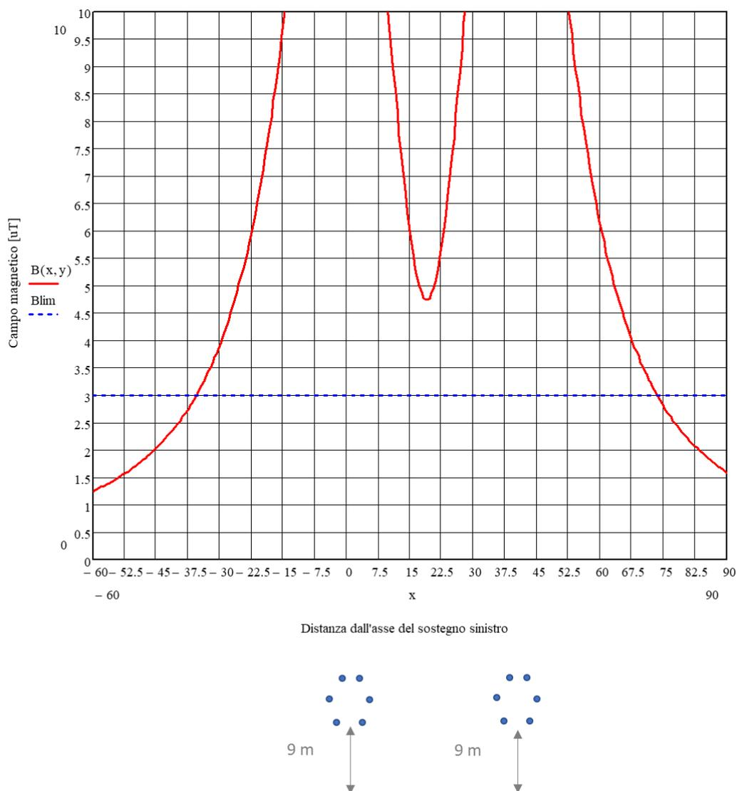
**Figura 10-1 – Calcolo del campo magnetico ad 1,5 metri dal suolo**
