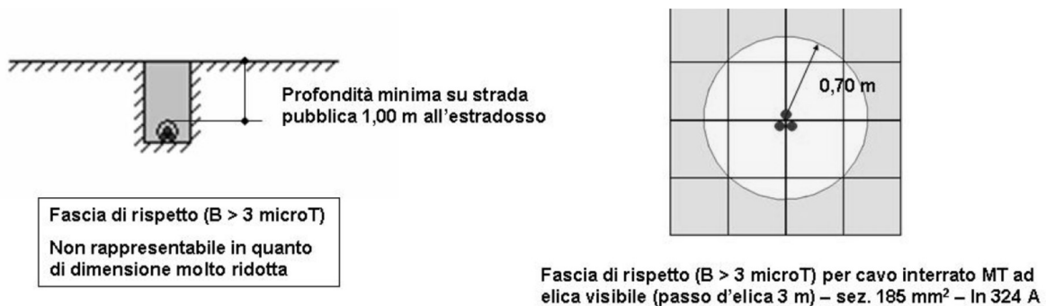
Estratto della guida di Enel sul calcolo della DPA: cavi in media tensione interrati
