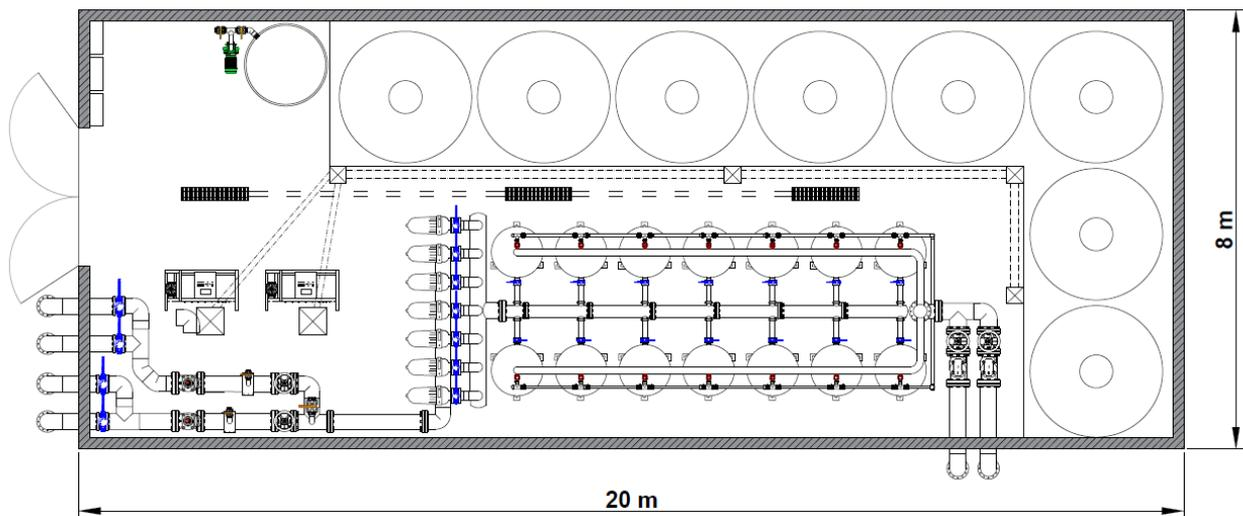
*Figura 38: Planimetria Cabina di manovra con centro di comando e banco fertirrigazione*
