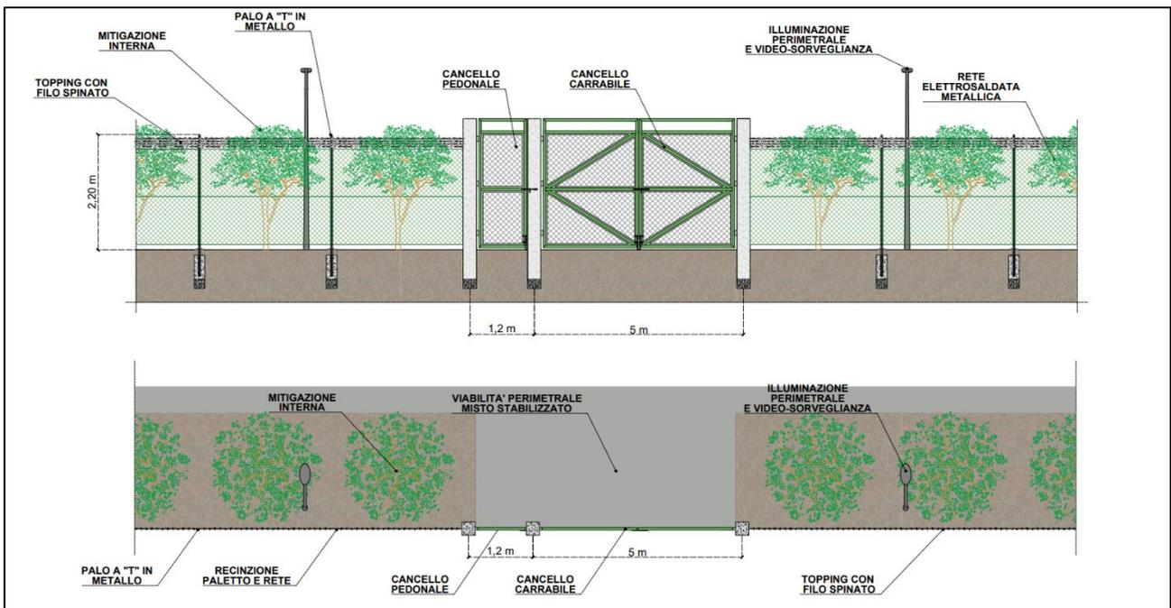
Figura 35: Immagine della recinzione dell'area, composta da una componente metallica e da una siepe di mitigazione.
