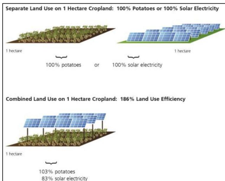
Figura 41: Rappresentazione delle varie tipologie di utilizzo del suolo, agricolo, con moduli fotovoltaici a terra e combinato, così da abbattere il consumo di suolo per l'uno o per l'altro utilizzo. Dal progetto “Agrophotovoltaics Resource Efficient Land Use (APV-RESOLA)” condotto dall'ISE e dell'Università di Hohenheim tra il 2017 e il 2019.
