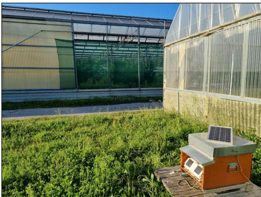
Foto 7: Arnia posizionata nell'impianto calabrese di Scalea. Si nota un piccolo pannello solare posto sull'arnia, che alimenta i sensori per misurare i parametri di seguito descritti.
