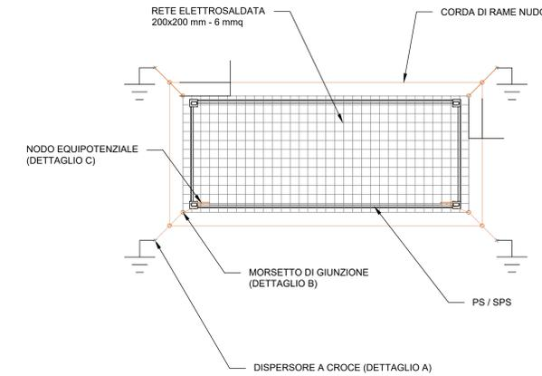
DETTAGLIO A - POZZETTO DI TERRA CON DISPERSIONE A CROCE
