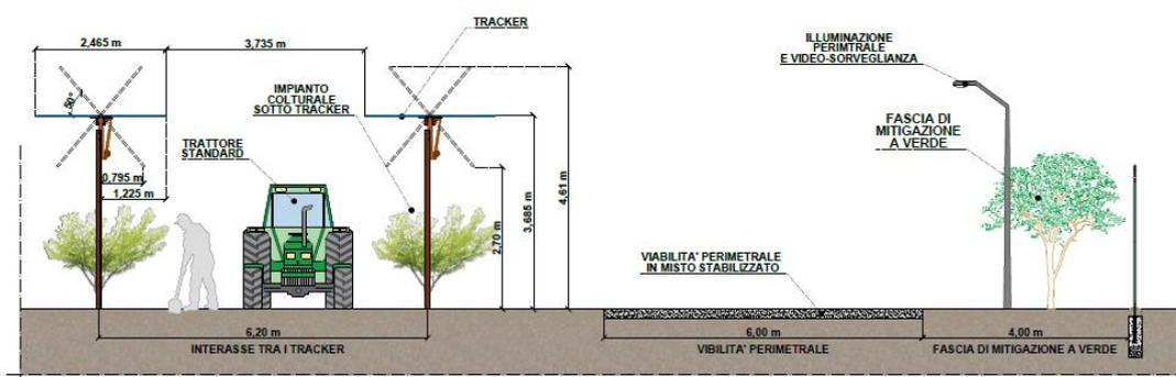
Figura 5: Visualizzazione schematica di una sezione di impianto. Sono visibili dettagli costruttivi (recinzione, opere di mitigazione e viabilità perimetrale).
