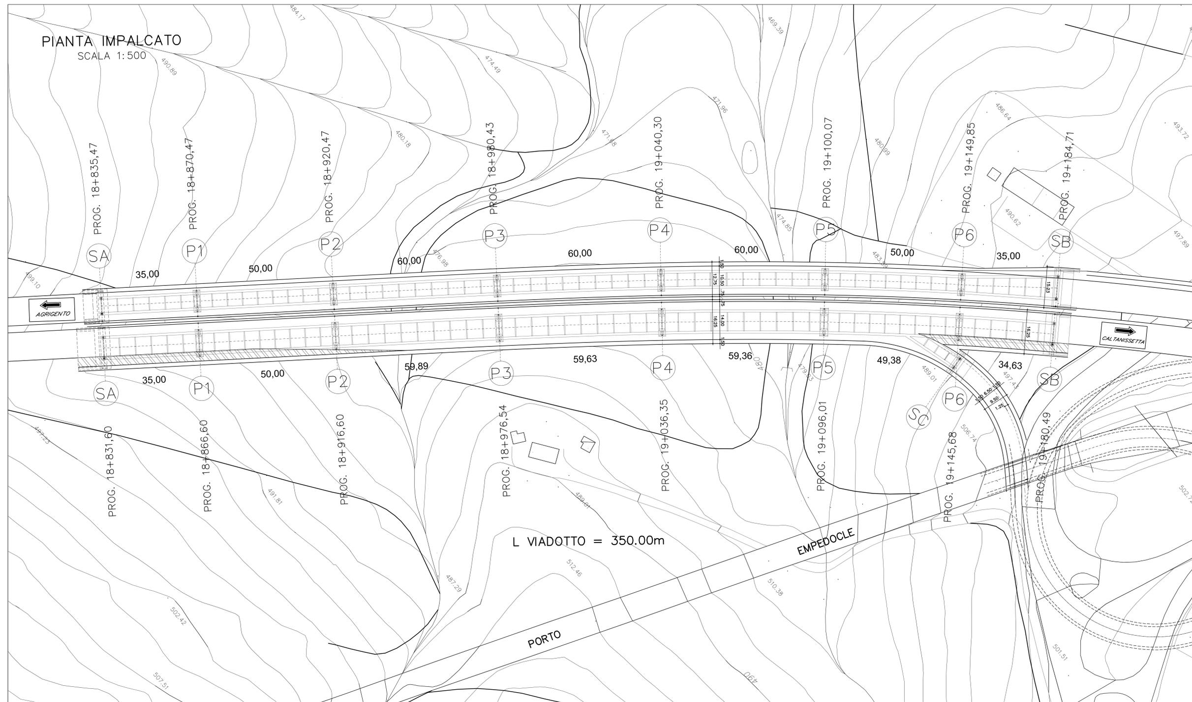
N.B. : GLI INTERASSI PILE SONO MISURATI SULL'ASSE IMPALCATO
