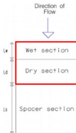
Figura 8.8 - Modulo tipo, descrivente il modello concettuale idrologico dell'installazione di strutture fotovoltaiche a tracker su pali infissi comprendente l'area pannelli (in rosso) e l'area di interfila (Fonte: Hydrologic response of solar farm Cook 2013 American Society of Civil Engineers).
