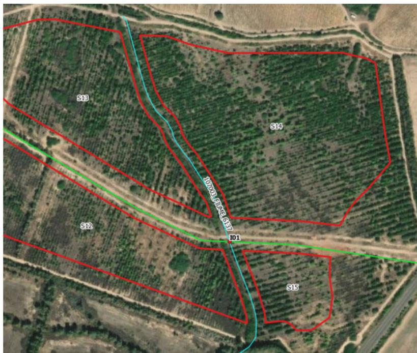
Figura 6.5: Ortofoto interferenza I01. In verde la linea di connessione, in rosso il layout di progetto e in azzurro il reticolo idrografico.
