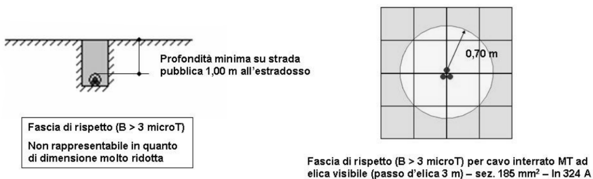
Figura 3.9: Sezione scavo tipo posa cavidotti.
