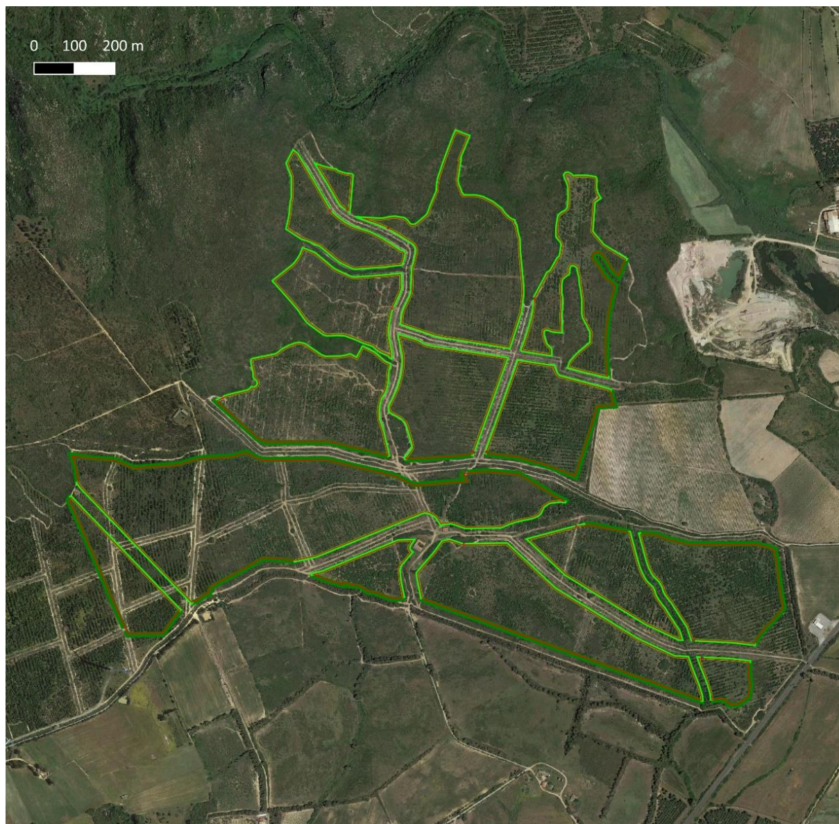
Figura 12.9: Localizzazione delle opere a verde di mitigazione (cfr. Rif. 2983_5376_CA_VIA_T07_Rev0_Layout di Progetto). In verde chiaro la fascia vegetata di larghezza 3 m, in verde scuro la fascia vegetata di larghezza 5 m, in rosso l'area recintata dell'impianto.
