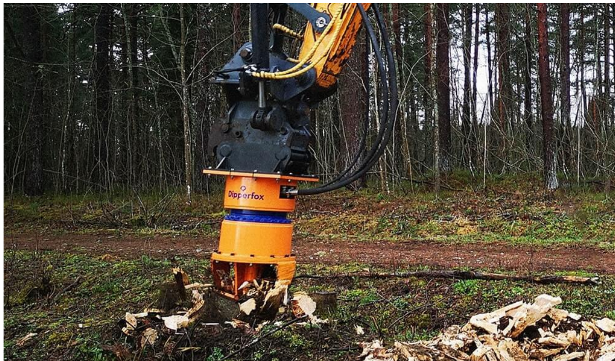
Figura 3.7: Fresaceppi in azione
