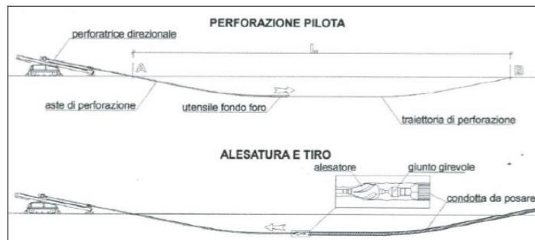
Figura 13: Schematico di trivellazione orizzontale controllata.
