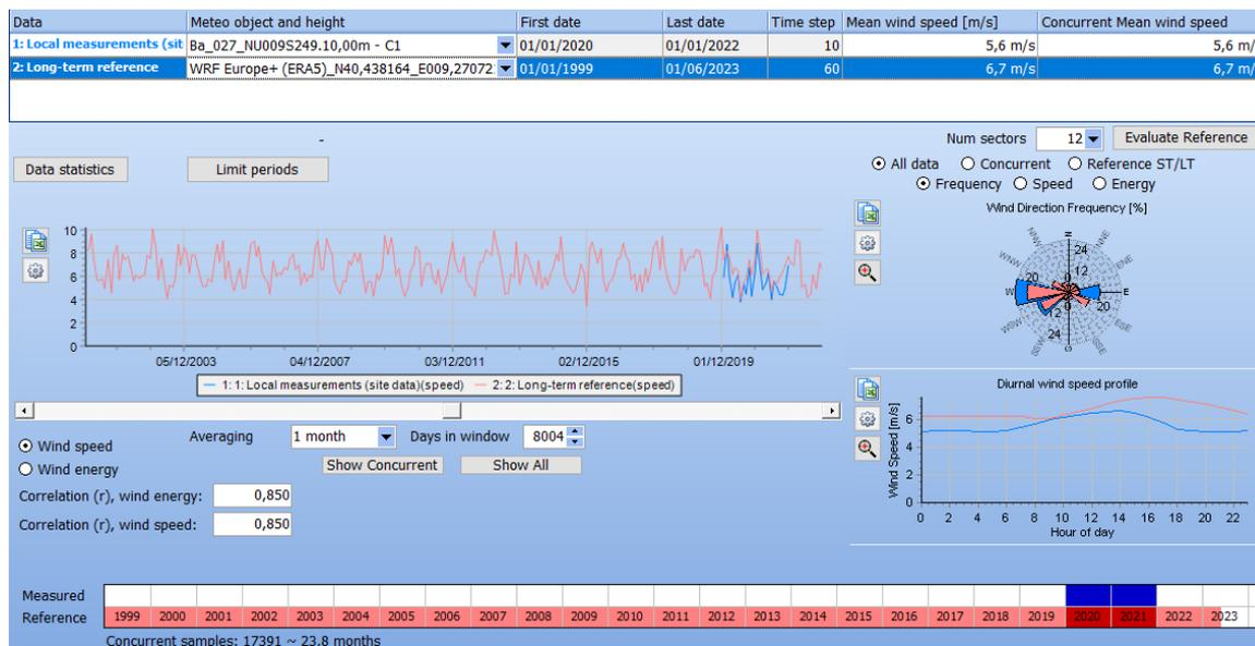
Figura 10: Correlazione dati stazione Ba\_027\_ NU009S249 con dati satellitari WRF Europe+\_N40,438164\_E009,270721
