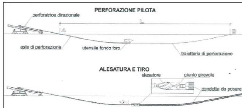
Figura 13: Schematico di trivellazione orizzontale controllata.
