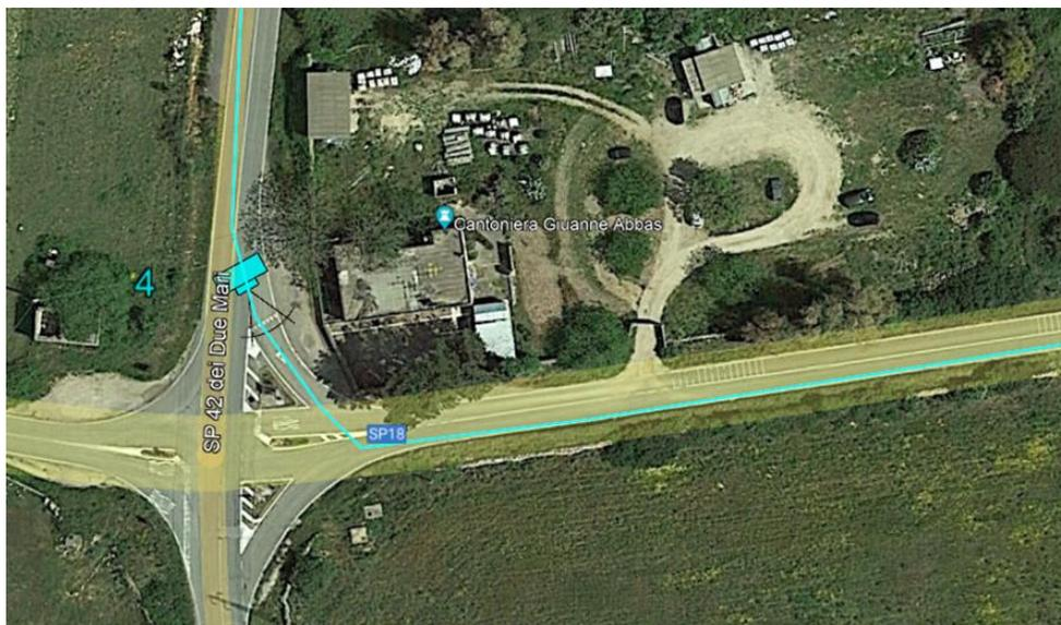
ADEGUAMENTO: rimozione cartelli, isole spartitraffico, muretto a secco e ampliamento strada
