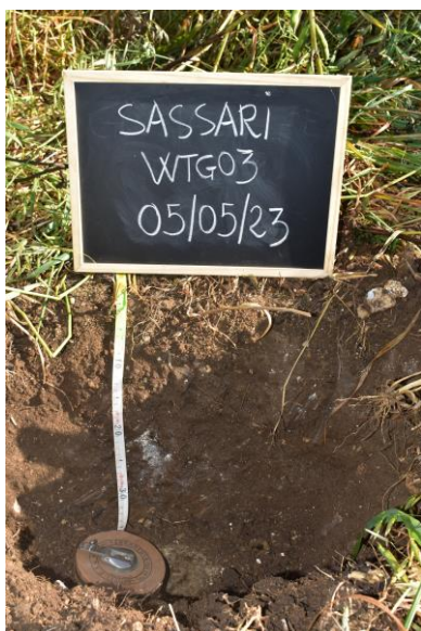
Figura 8 - Sito in cui è prevista l'installazione dell'aerogeneratore WTG03 nel territorio di Sassari, in basso il minipit effettuato nel punto rilevato
