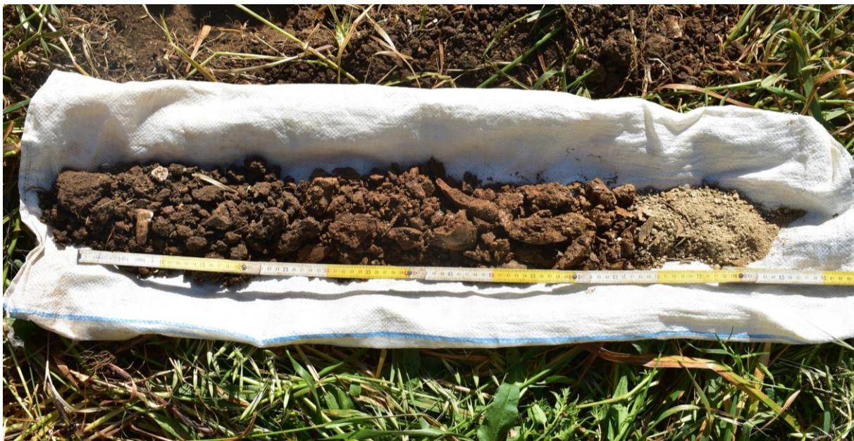
Figura 9 – Trivellata eseguita a completamento del rilevamento
