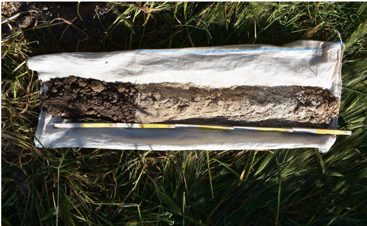
Figura 30 - Trivellata eseguita a completamento del rilevamento
