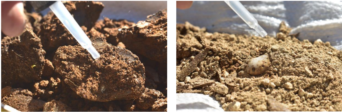
Figura 11 – Test dell’effervescenza con HCl per verificare il grado dei carbonati presenti nei vari strati. A sinistra orizzonte Bt a destra orizzonte Ck che mostrano una netta differenza nella reazione.
