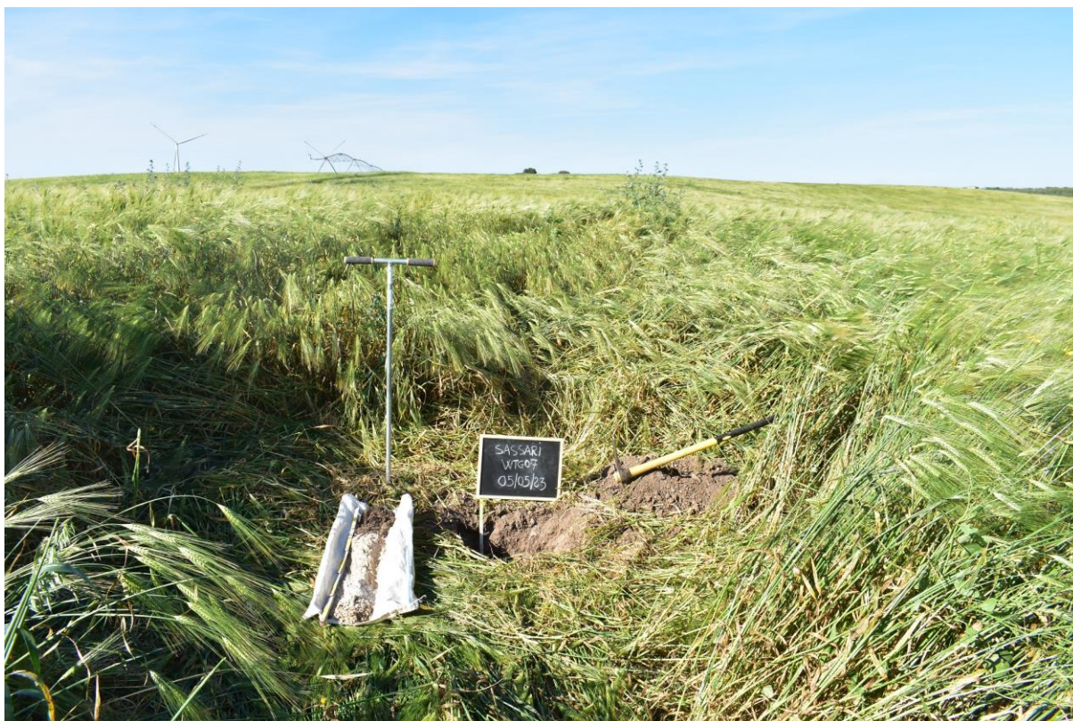
Figura 29 - Sito in cui è prevista l'installazione dell'aerogeneratore WTG07 nel territorio di Sassari, in basso il minipit effettuato nel punto rilevato
