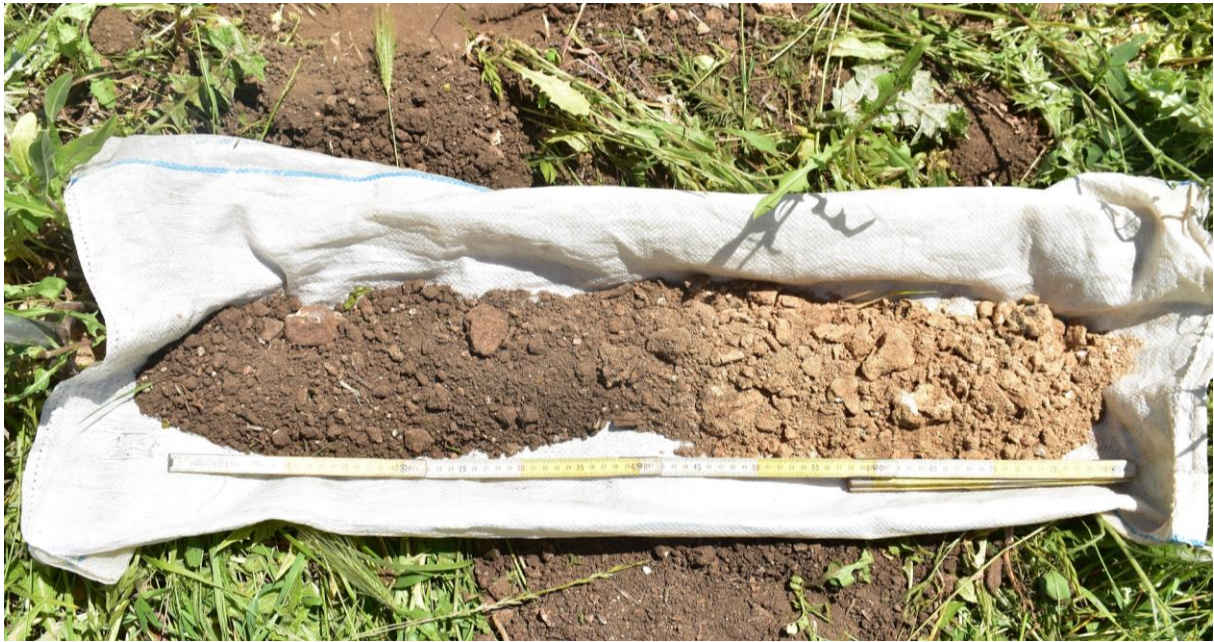
Figura 15 - Trivellata eseguita a completamento del rilevamento
