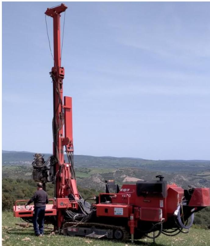
Figura 38 Sonda idraulica EGT VD710
