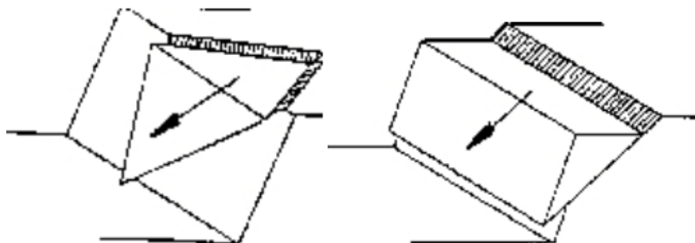
Figura 14 tipologie di scivolamento di blocchi rocciosi lungo piani di fratturazione
