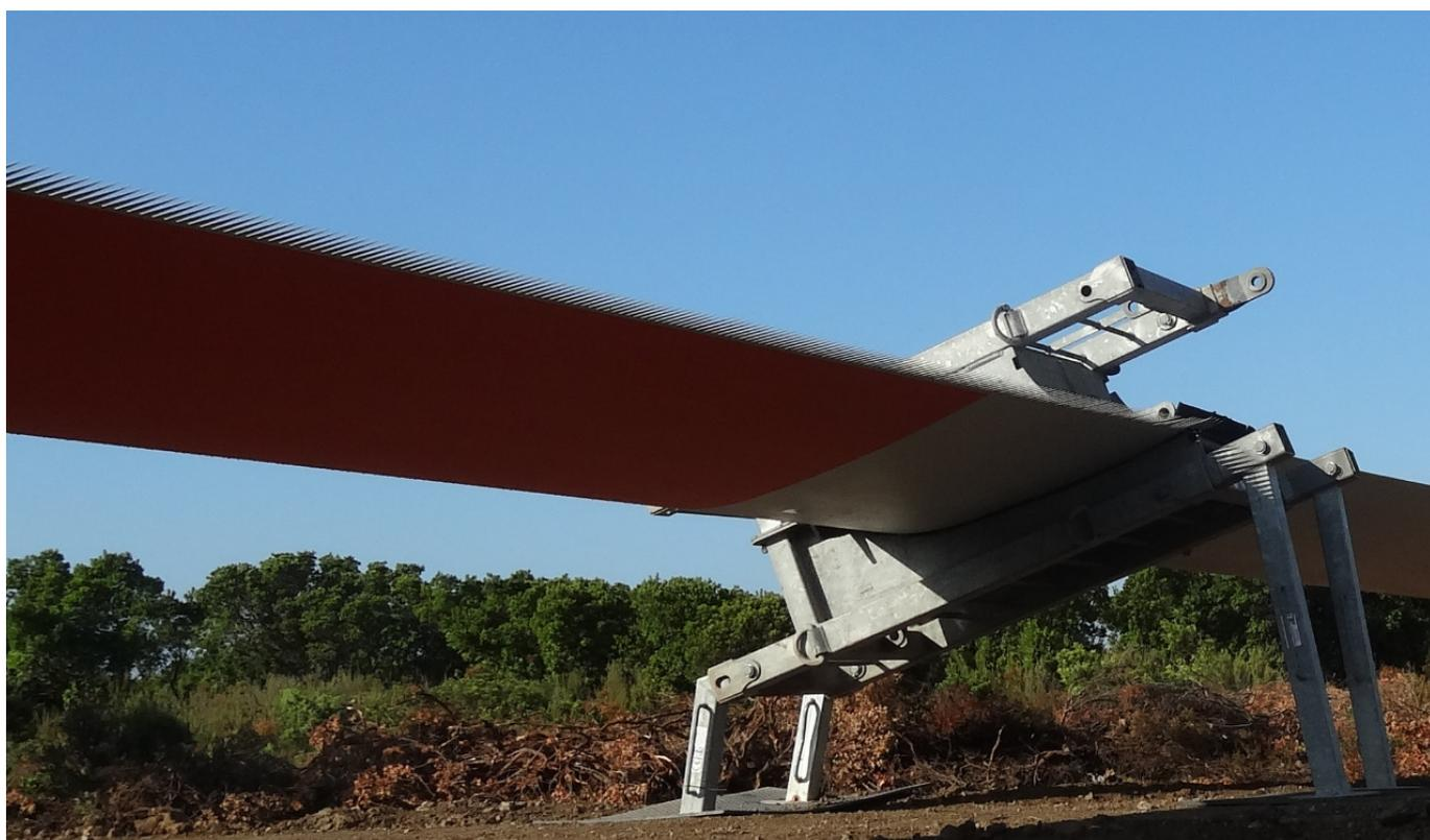
*Figura 6 Pala di aerogeneratore con bande dentellate*
