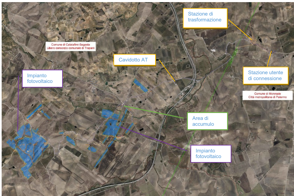
Figura 3.2 Inquadramento impianto in progetto
