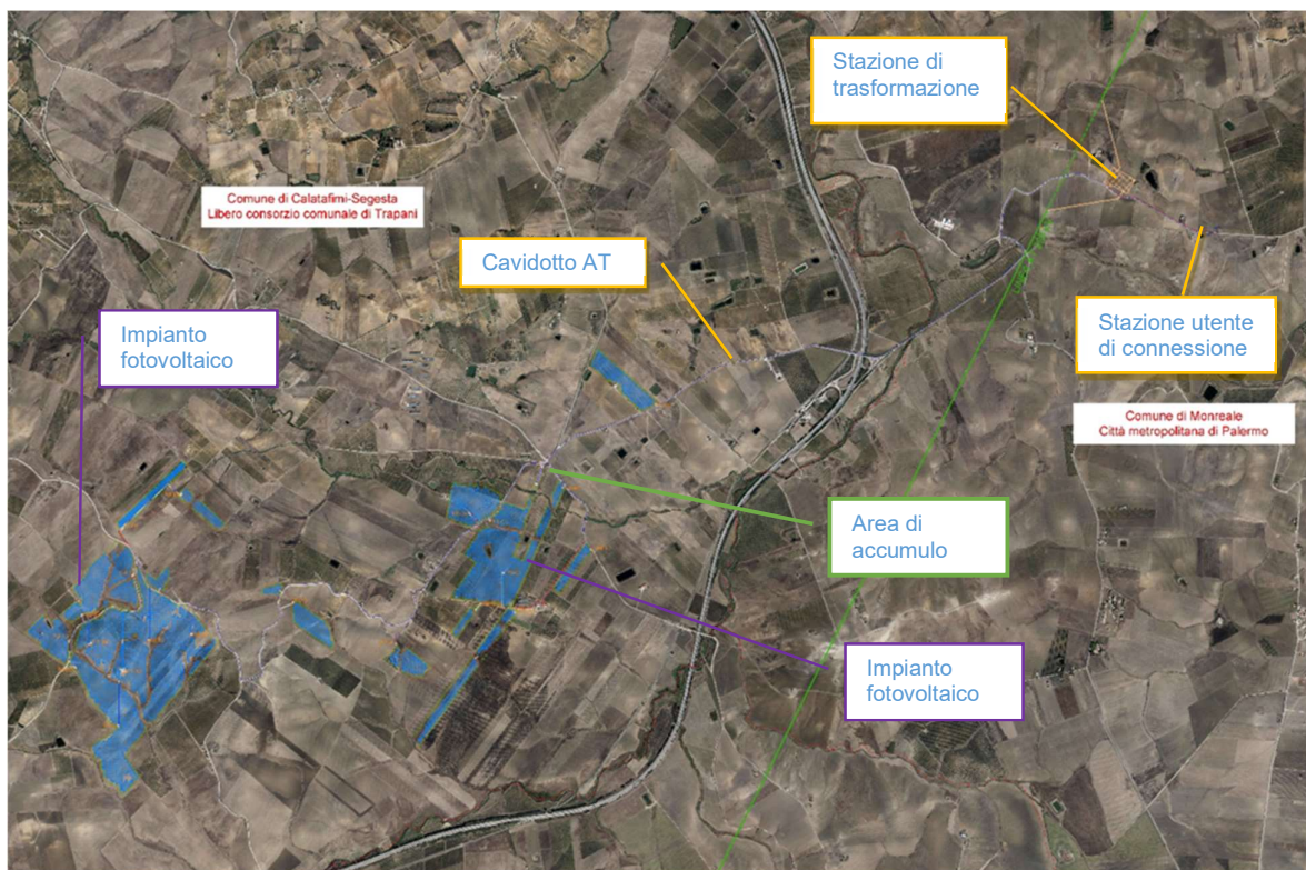
Figura 3.2 Inquadramento impianto in progetto
