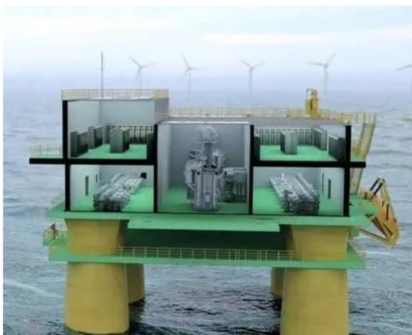
Figure 26/27/28 – Esempio di Stazione HVAC di trasformazione 150/380 kV.
