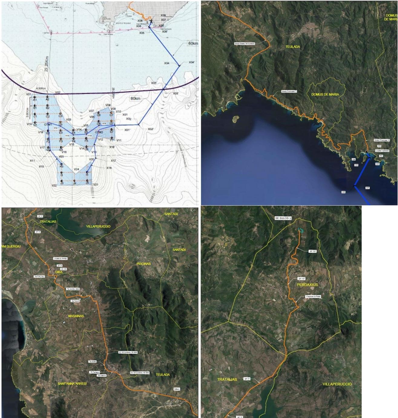
**Figg. 6a, 6b, 6c, 6d – Layout impianto offshore e tracciato dei cavi su terraferma.**
