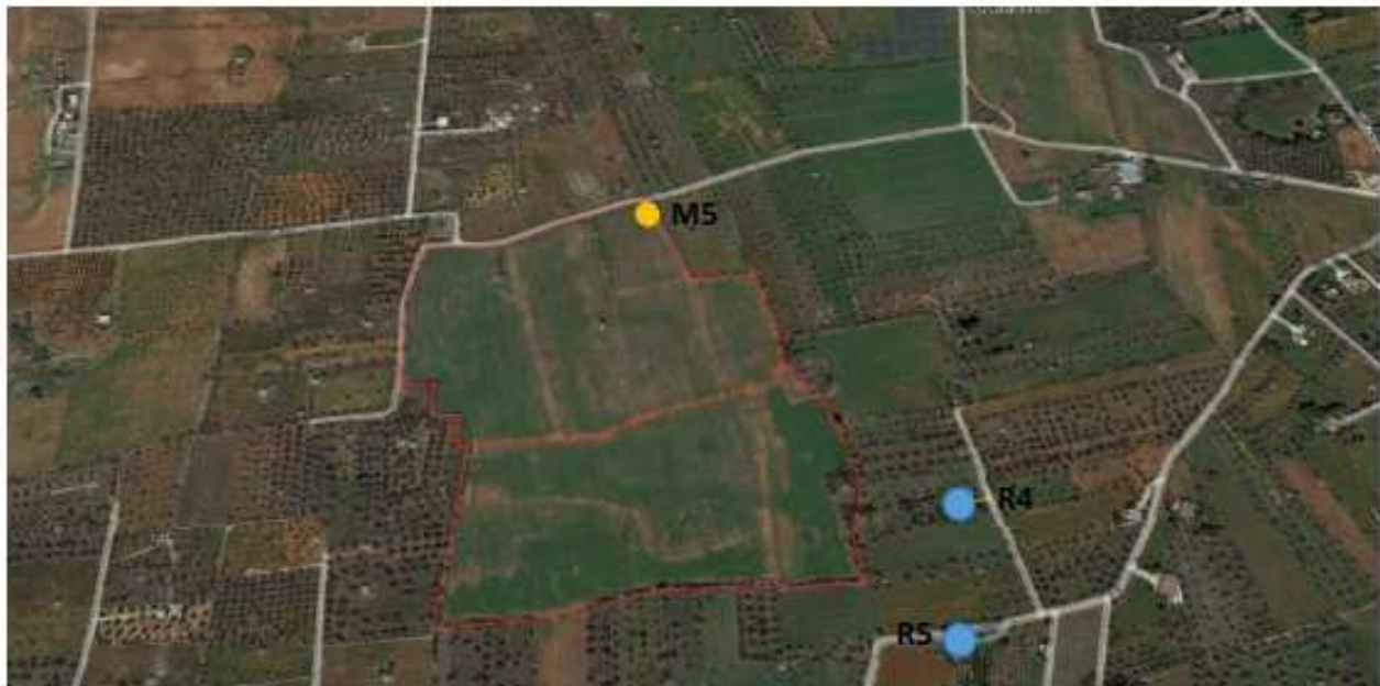
Indicazione dei ricettori (pallini azzurri), futura stazione elettrica Specchia-Galatina (contorno rosso) nel Comune di Galatina, dei punti di misurazione di Leq(A) (pallini gialli)
