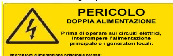
Figura 48 - Segnaletica da utilizzare per i lavori sugli impianti FV
