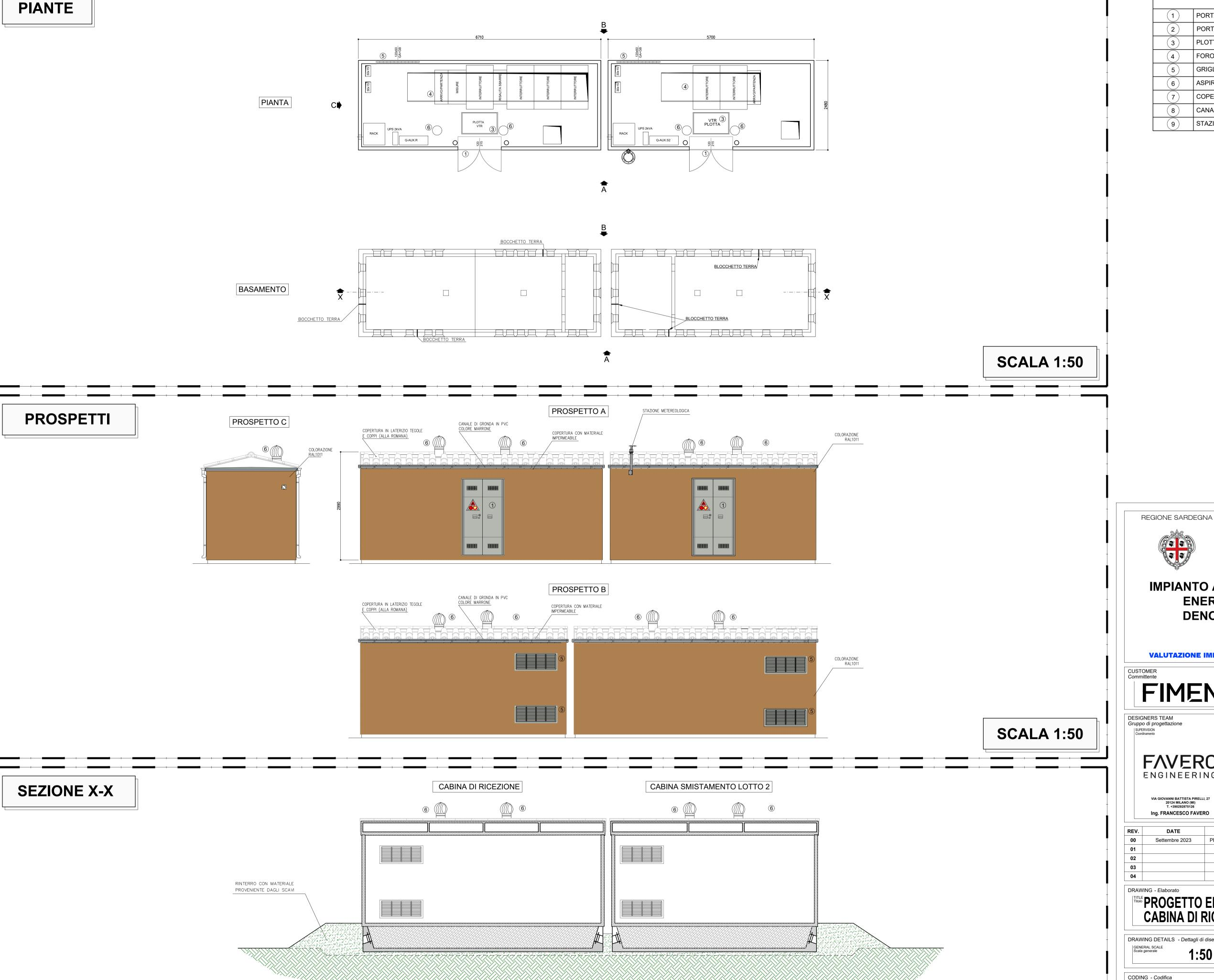
LEGENDA PORTA A DUE ANTE cm120Xh215 PORTA ANTA UNICA cm 60Xh215 PLOTTA IN VTR PER ACCESSO ALLA VASCA cm100X60 FORO QUADRI MT cm280x80 GRIGLIA ALTA E BASSA IN VTR cm120Xh50 ASPIRATORE EOLICO COPERTURA IN LATERIZIO TEGOLE E COPPI (ALLA ROMANA) CANALE DI GRONDA IN PVC COLORE MARRONE STAZIONE METEREOLOGICA
