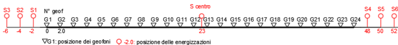
Figura 9 Schema geometrico di acquisizione dei dati per gli stendimenti di lunghezza L = 46,0 m
