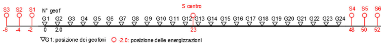
Figura 37 Schema geometrico di acquisizione dei dati per gli stendimenti di lunghezza L = 46,0 m
