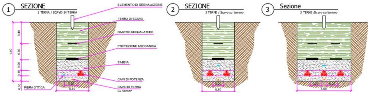
Figura 24 - Cavidotti MT terreno agricolo
