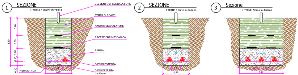
Figura 52 - Sezioni tipo di scavo su terreno
