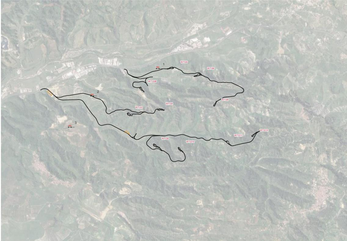
Figura 9 - Planimetria di ubicazione delle indagini sismiche MASW.
