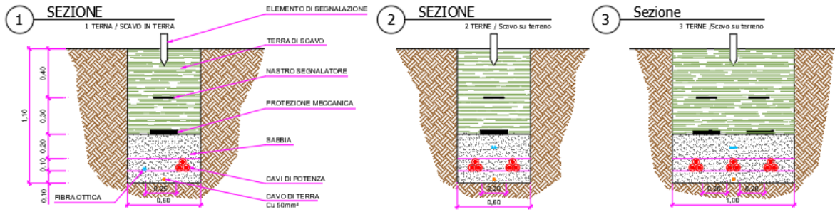
Figura 13 - Sezioni tipo di scavo su terreno
