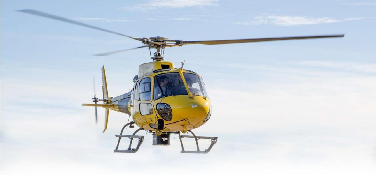
Figura 5 - Elicottero AS 350 B3 in assetto di volo equipaggiato con la strumentazione per il rilievo
