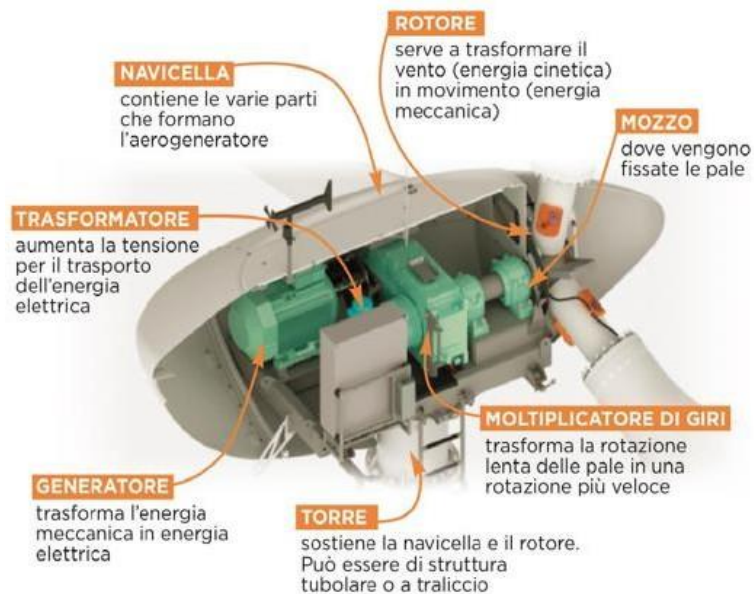
Figura 4 - Spaccato turbina eolica
