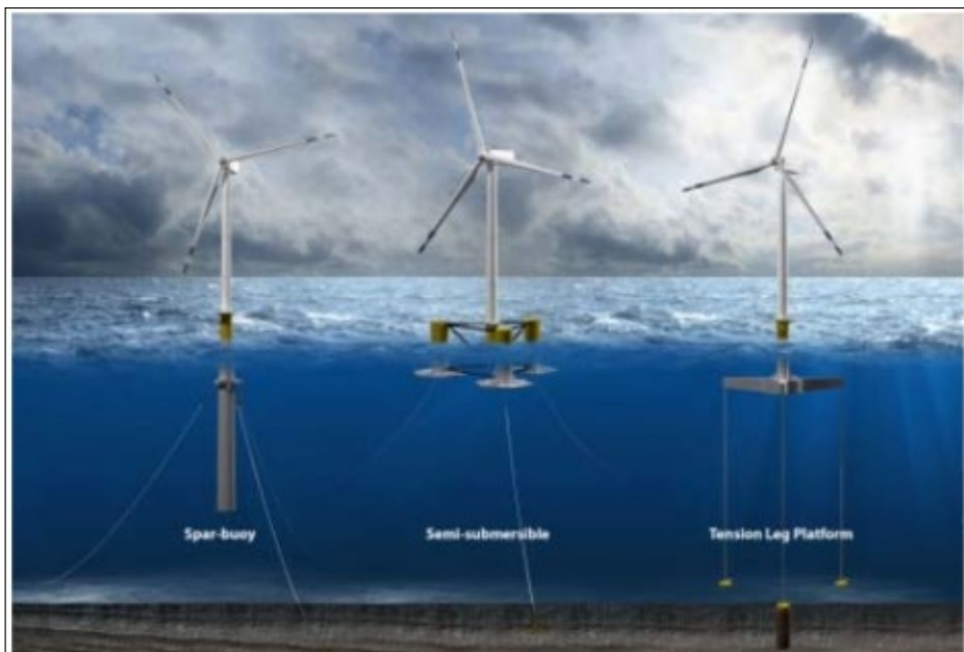
Figura 6 - Sistemi di ancoraggio
