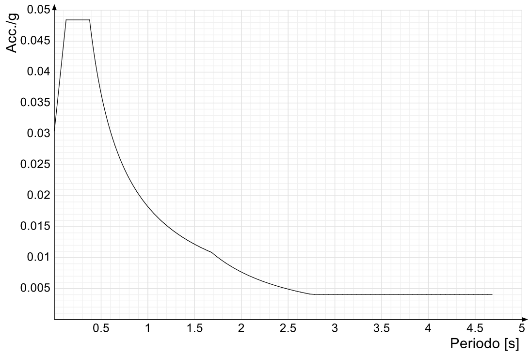
Spettro di risposta di progetto in accelerazione della componente X SLD § 3.2.3.5
