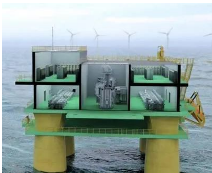
Figure 26/27/28 – Esempio di Stazione HVAC di trasformazione 150/380 kV.
