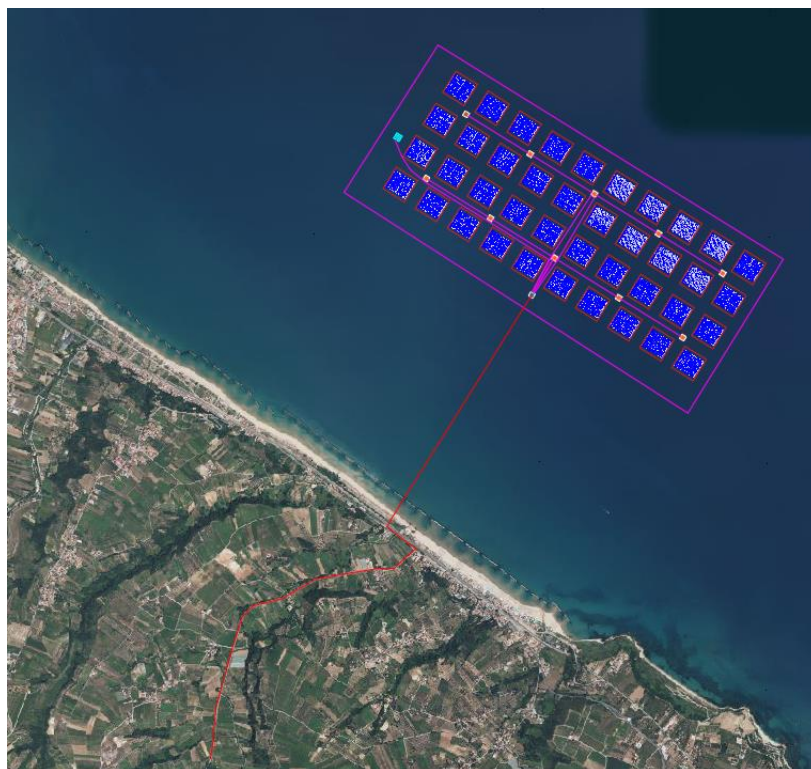
Figura 6: schema di collegamento dell'impianto fotovoltaico e BESS
