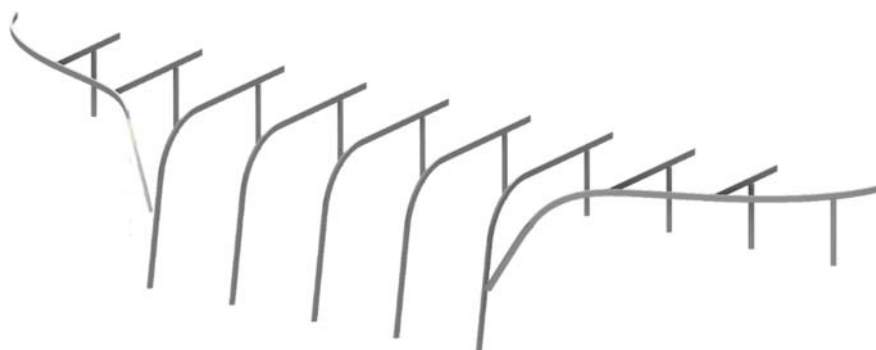
Figura 2-13: Schema struttura portante della pensilina
