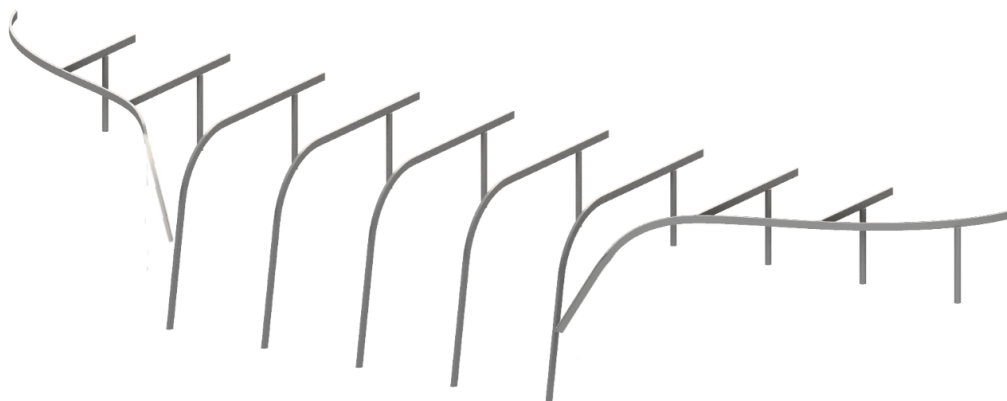
Figura 39 – Schema struttura portante della pensilina
