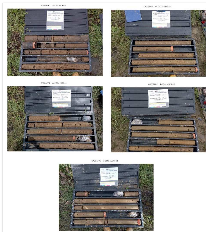
Figura 6-34 Foto carote sondaggio SG007
