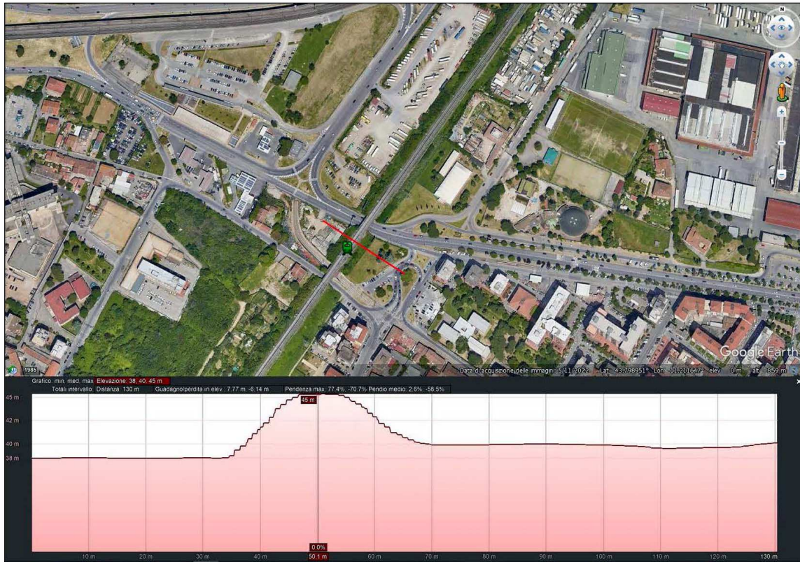
Figura 1-2 Inquadramento di dettaglio dell'area e profilo del terreno NO-SE ricavato da Google Earth Come si può vedere la linea ferroviaria nell'area prevista per la realizzazione della nuova stazione ferroviaria corre su di un rilevato dell'altezza approssimativa di 7 m.
