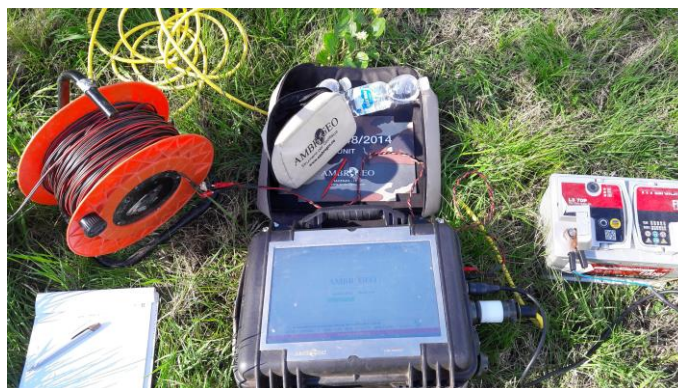
Figura 2.1.1.1: Sismografo digitale a 24 bit.
