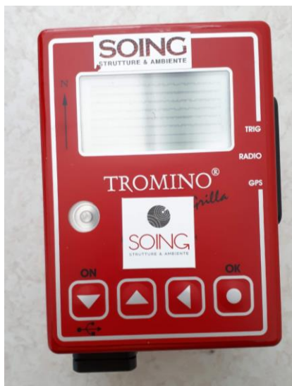
Figura 2.2.2.1: Tromografo per la misura microtremori - TROMINO©Engi
