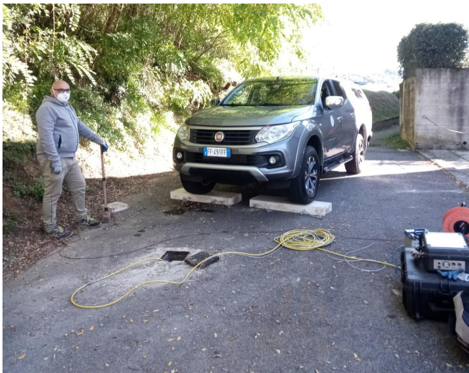
Figura 2.2.2.1: configurazione standard per le indagini Down Hole
