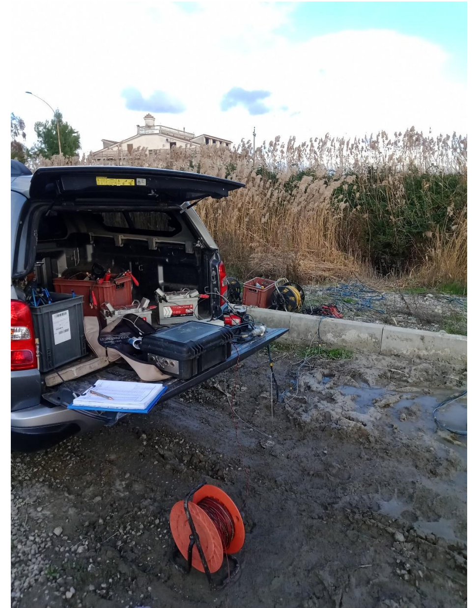
Foro di sondaggio S2-DH allestito per la prova Down Hole
