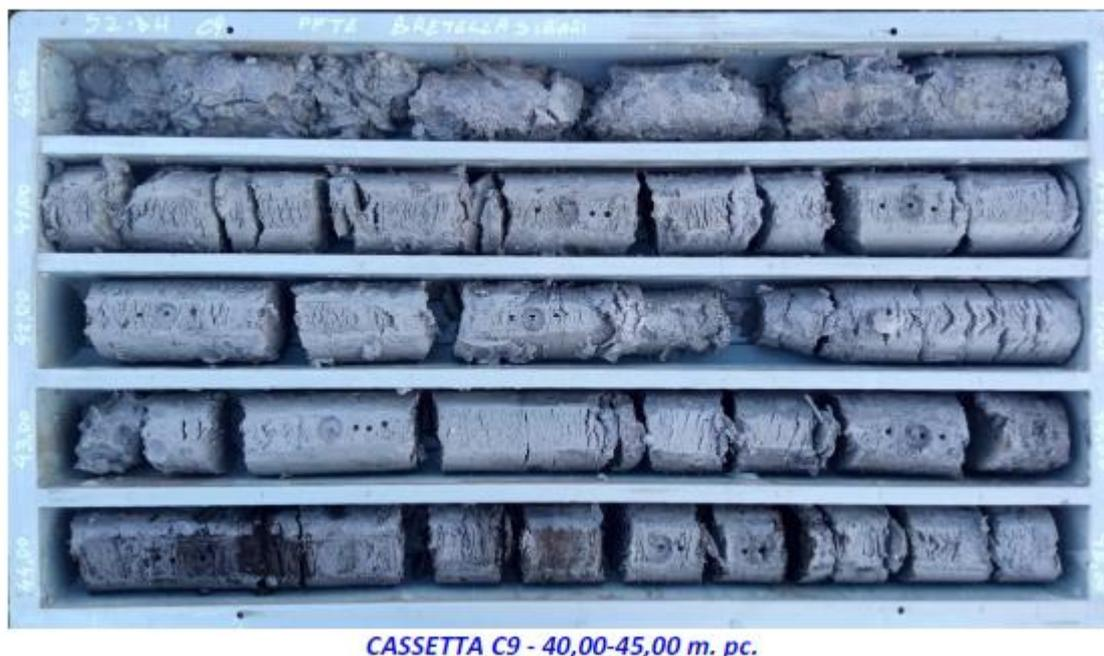
Figura 31: Fotografia di una cassetta della campionatura estratta alla profondità dell'unità geotecnica UG3.
