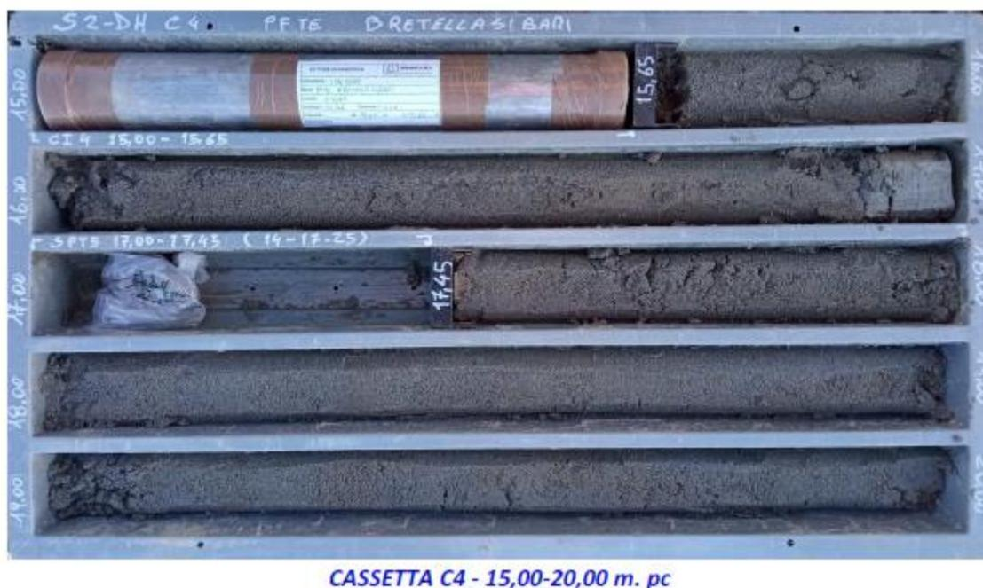
Figura 25: Fotografia di una cassetta della campionatura estratta alla profondità dell'unità geotecnica UG2.
